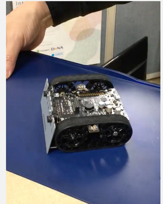
Zumo (CPU: ATmega328p 16MHz, Flash: 32KB, RAM: 2KB)
