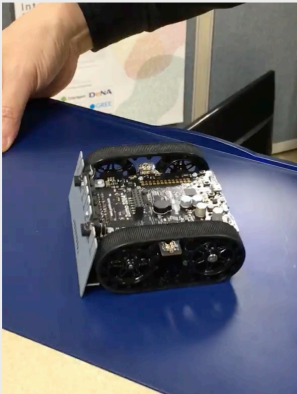
Zumo (CPU: ATmega328p 16MHz, Flash: 32KB, RAM: 2KB)
